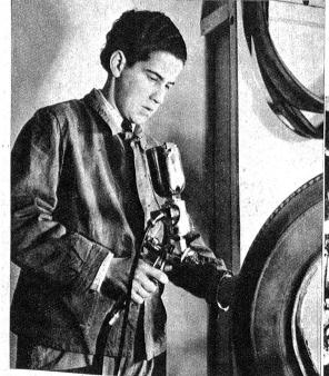
Oben: Eine epochale Schweizer-Erfindung hat ein neues Kunstgummi-Spritzverfahren ermöglicht, das durch Auffrischen bereits brüchiger und ausgetrockneter Reifen diese wieder gebrauchsfähig macht.
