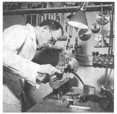
Die Reparatur und Pflege von Pendulen beanspruchen nicht nur eine werkzeugreiche Werkstätte, sondern auch besondere Kenntnisse. Auf einer Drehbank wird ein neues Zahnrad tür eine Pendule angefertigt
