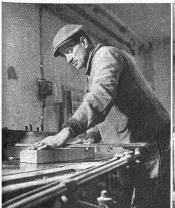
Bestandteile der Formkasten werden in der Schreinerei nach den angegebenen Massen hergestellt
