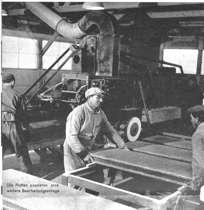
Die rohen Platten werden dem ersten maschinellen Arbeitsgang zugebracht
