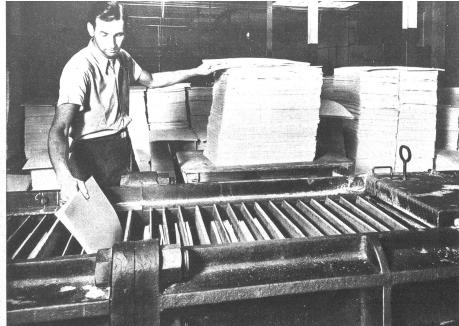
Die Zelluloseblätter werden in den flüssigen Zustand übergeführt
