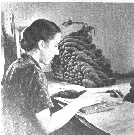
Die Strangen kommen in die Packerei und werden mit Strangenbändern versehen
