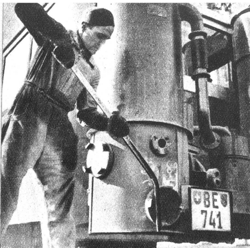
Mit einem langen Eisen wird der Generator unten geöffnet, um zum Roost zu gelangen
