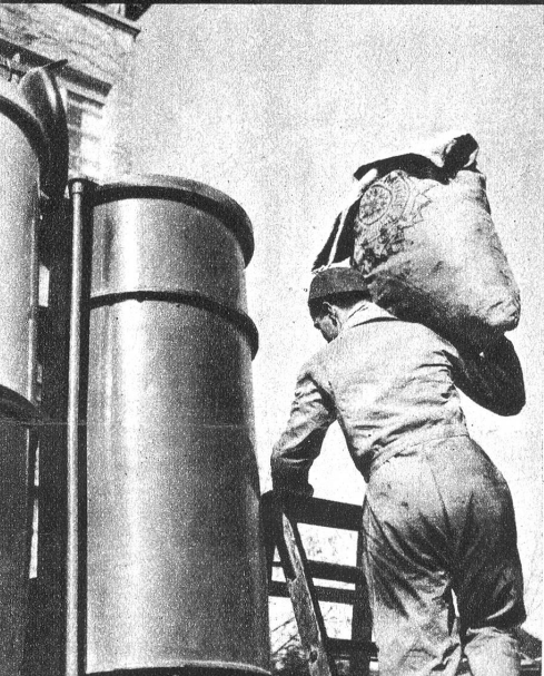
Zweimal 30 Kilo Holz werden eingefüllt, dann langts wieder für ein paar Stunden
