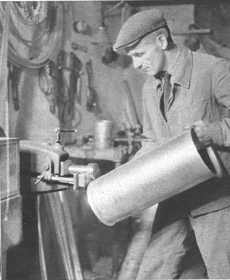
Bei der Rohrfabrikation. Mit Spezialmaschinen werden die Rohre mit einem Bord versehen, um das Zusammenfügen der Rohrstöße zu ermöglichen
