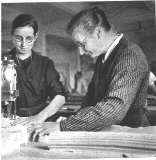
In der Hemdenfabrikation werden die Stücke mit der Handmaschine nach Muster zugeschnitten Unten links: Eine alte Kinderbluse, wie sie früher hergestellt wurde und die heute vollkommen aus dem Verkehr gekommen ist
