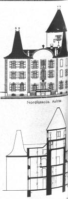
Querschnitt. Durch seine Mauerdick fü zwei Meter) ist der alte Wehrlurm dis ster Bauteil deutlich erkennbar
