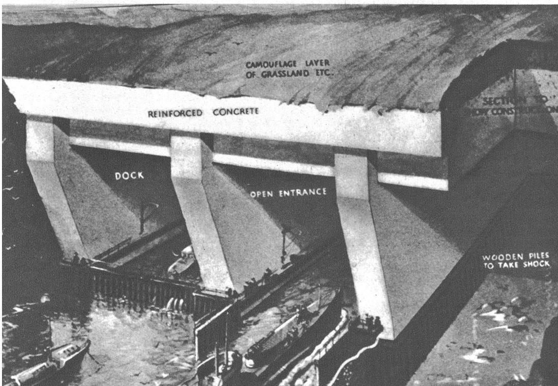
Bombensicheres Unterstand für Unterseeboote in einer Stützpunkt der norwegischen Küste. Die ganze Stützpunktanlage besteht aus Stahlbeton und das gedeckte Dock bietet vollständig Sicherung. Nicht nur für Unterseeboote, sondern auch für alle Schiffseinheiten, die sich in diesen Unterständen befinden. (Siehe gleichnamiges Artikel Seite 442.)
