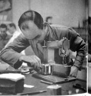
Die Montage und das Einsetzen des kleinen Moloss, des Schraube muss nachkontrolliert und wenn notig welcher in die Nähmaschine einkonstruiert ist, stellt techgezogen werden. eine der letzten Arbeiten in der Montage dar.
