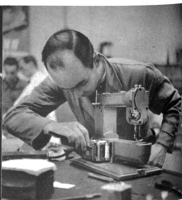
Die Montage und das Einsetzen des kleinen Molots, welcher in die Nähmaschine einkonstruiert ist, stellt eine der letzten Arbeiten in der Montage dar.
