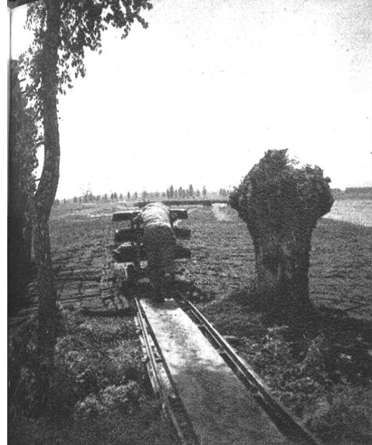
Mit Rollwagen wird der Torf auf die weiten Felder zum Trocknen geführt.
