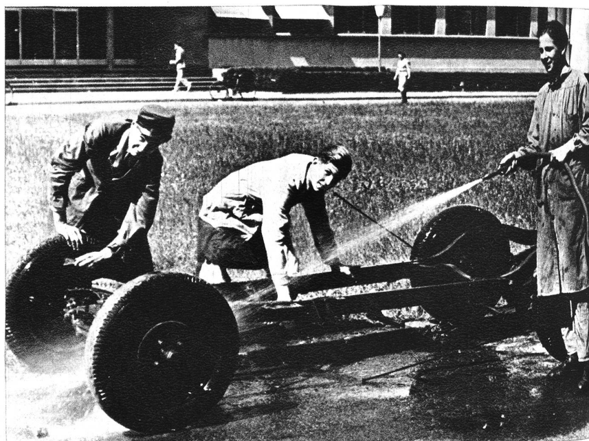
Das Gestell eines alten Autos wird sorgfältig gereinigt und demontiert, um daraus ein Fahrgestell für das Segelflugzeug herzustellen.
