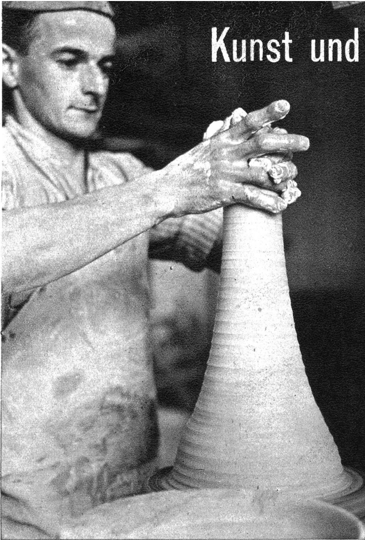
Das Rohprodukt der Porzellanmasse, die Porzellanerde, wird unter der kundigen Hand des Meisters auf der Drehscheibe gehörig durchgearbeitet.
