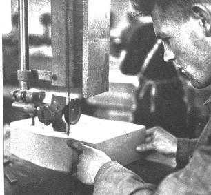
Aus dem Block werden die Holzböden in Rohform herausgefräst.
