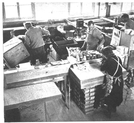
Mittels Schablonen werden auch die Korkplatten möglichst rationell ausgenützt.
