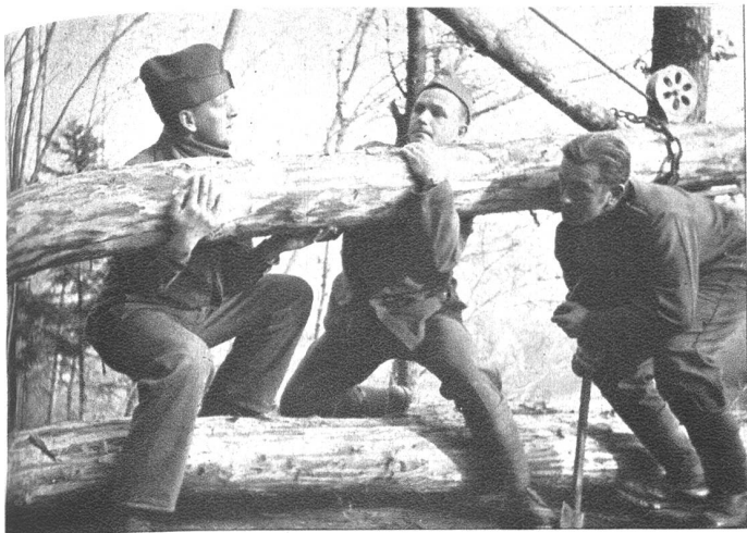
Auf der Holz Bühne werden die Trämel mit mehr oder weniger lauten Kommandos gehoben und vermittelst Ketten und Klammern am Seilzug befestigt.
