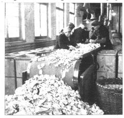
Hier werden die Zinntuben und alles, was nicht Stanniol ist, ausgeschaltet. Am Ende des laufenden Bandes ergiesst sich eine gleissende Flut von reinem Silberpapier auf den Boden, das in Körben wesgetragen, gepresst, eingeschmolzen — zugunsten der Soldatenwäsche-Fürsorge "versilbert" wird.
