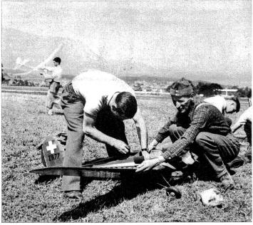
Eine Nachbildung des populären roten Lockheed Flugzeuges Walter Mittelholzers (1932) zeigt, dass der Modellflugbau keine blosse Spielerei ist, sondern auch von Erwachsenen ernst genommen wird. Auf der Startfläche wird der Propeller angeworfen und die Umdrehungszahl des Einfünftel-PS-Motörchens reguliert — der Flug kann beginnen.
