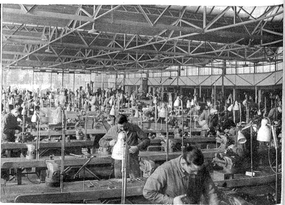
Montage von Schraubstöcken in der Mechaniker-Werkstätte. Der Abteilungsmeister kontrolliert die ausgeführte Arbeit. Die Mechaniker-Abteilung in den Lehrwerkstätten.
