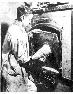
Die Ofenture wird sorgfältig verschlossen und mit Lehm abgedichtet. Mit Holzfeuerung wird er allmählich auf eine Temperatur von ca. 650—700 Grad gebracht.
