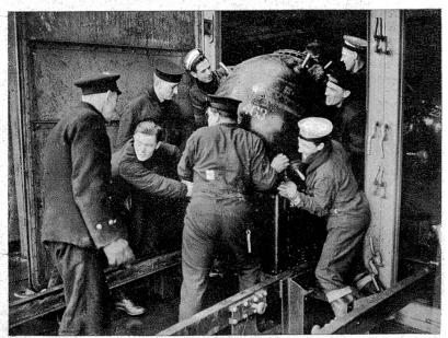
Die Mine ist zum Abwurf bereit. Sie explodiert, wenn ein Schiff einen der seitlich angebrachten Zapfen berührt und abstösst. Die verheerende Wirkung der grossen Sprengladung bewirkt, dass ein Schiff oft nach wenigen Minuten versinkt
