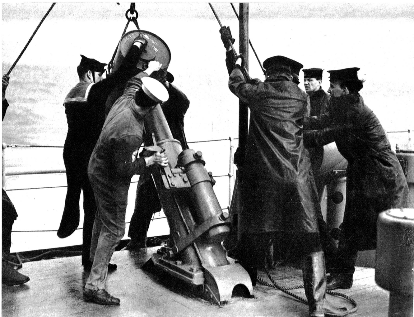
Eine Tiefseemine wird von einem Unterseeboot-Zerstörer aus durch eine Art Katapultschleuder ausgeworfen.
