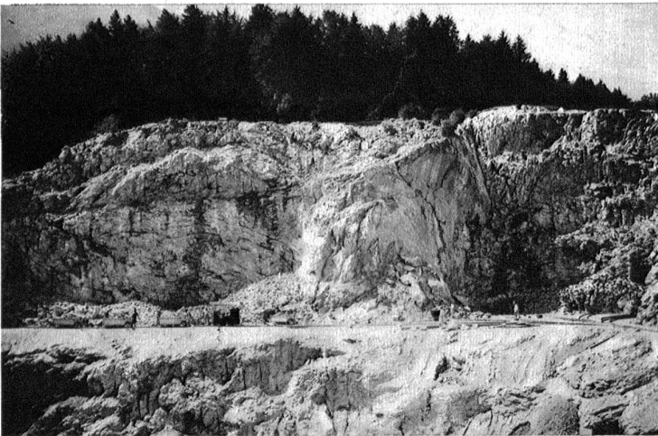
Wo das Rohmaterial für die Zementfabrikation herkommt: Die Kalkmergelgrube Oberacker. In der Mitte des Steinbruchs sieht man deutlich die härteren Kalkschichten hervorstechen. Links und rechts weiche Mergel.
