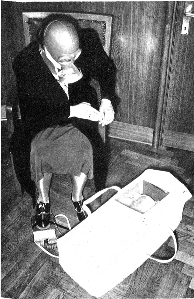
Der transportable und fahrbare Gasschutzraum für Säuglinge.
