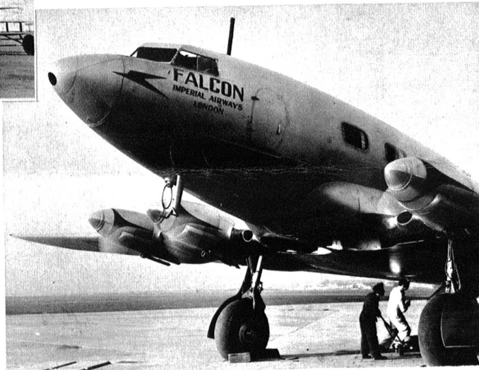
Das Vi:rmotorenflugzeug „Fa'con“ der Imperial Airways, das im Flugdienst Zürich-London eingesetzt wird. Flugdauer Dübendorf-Croydon: 153 Minuten. 22 Passagiere, vierköpfige Besatzung, Fracht und Post. Flügelspannweite 32 Meter, Gesamtlänge 22 Meter, Höhe 6.8 Meter. Höhe des Salons 1.9 Meter, komplett ausgerüstete Küche, Einziehbares Fahrgestell. 320 Stundenkilometer Verkehrsgeschwindigkeit.
