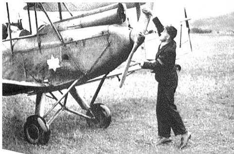
Vor dem Start. Der Motor wird von Hand in Betrieb gesetzt.
