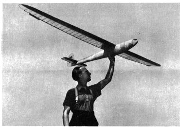
Elegantes Grossmodell: Flügel ungebrochen gerade. Flügelnase aus dünnstem Sperrholz, ebenso ist der auskonstruierte Rumpf mit Sperrholz beplankt. Auf der Rumpfnase befindet sich ein Trimmgewicht zur Veränderung der Gleichgewichtslage. Die kleinen Klappen an den Flügeln aus Aluminium dienen zur Verbesserung der Stabilität.
