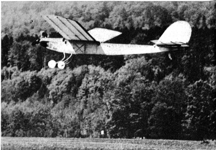
„Motormodell“ mit Zweitaktmotor. Führt Benzin für eine Flugdauer von 40 Min. mit sich. Gewicht 720 Gramm.
