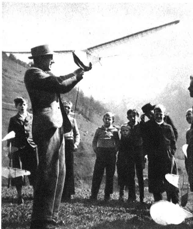
Vorbereitung zum Gummiseilstart: (Hochstart): An einem Starthaken wird das Gummiseil eingehängt und angepannt. Dann wird das Modell gegen den Wind losgelassen.
