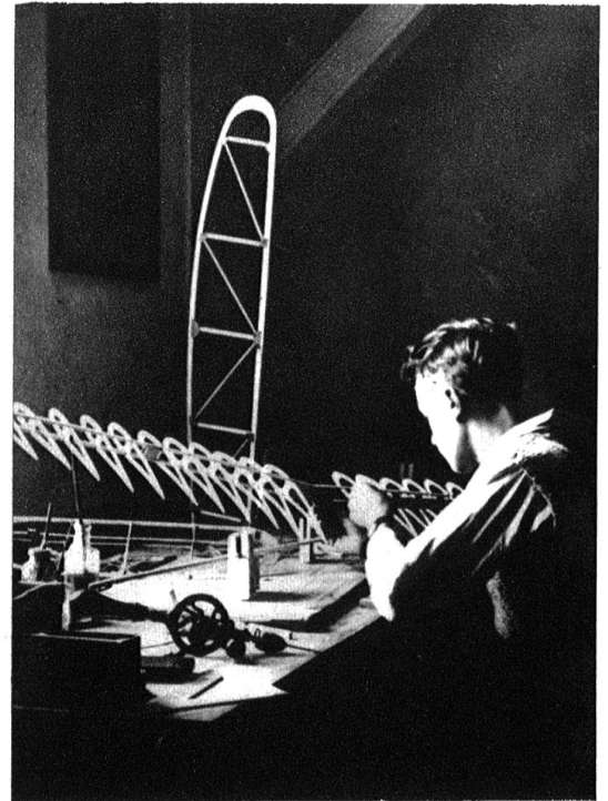
Flügel im Rohbau: Der junge Modellbauer setzt die Flügelrippen auf den Hauptholm. Diese Arbeit verlangt sehr viel Feingefühl, Ausdauer und Sorgfältigkeit. Im Hintergrund das Gerippe des Rumpfes. Das Dreieck als Bauelement.
