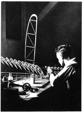
Flügel im Rohbau: Der junge Modellbauer setzt die Flügelrippen auf den Hauptholm. Diese Arbeit verlangt sehr viel Feingefühl, Ausdauer und Sorgfältigkeit. Im Hintergrund das Gerippe des Rumpfes. Das Dreicck als Bauelement.
