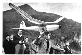
Erste Phase des Handstartes: Dieses Modell erreichte über 1000 m Startüberhöhung und legte eine Strecke von 7250 m zurück.
