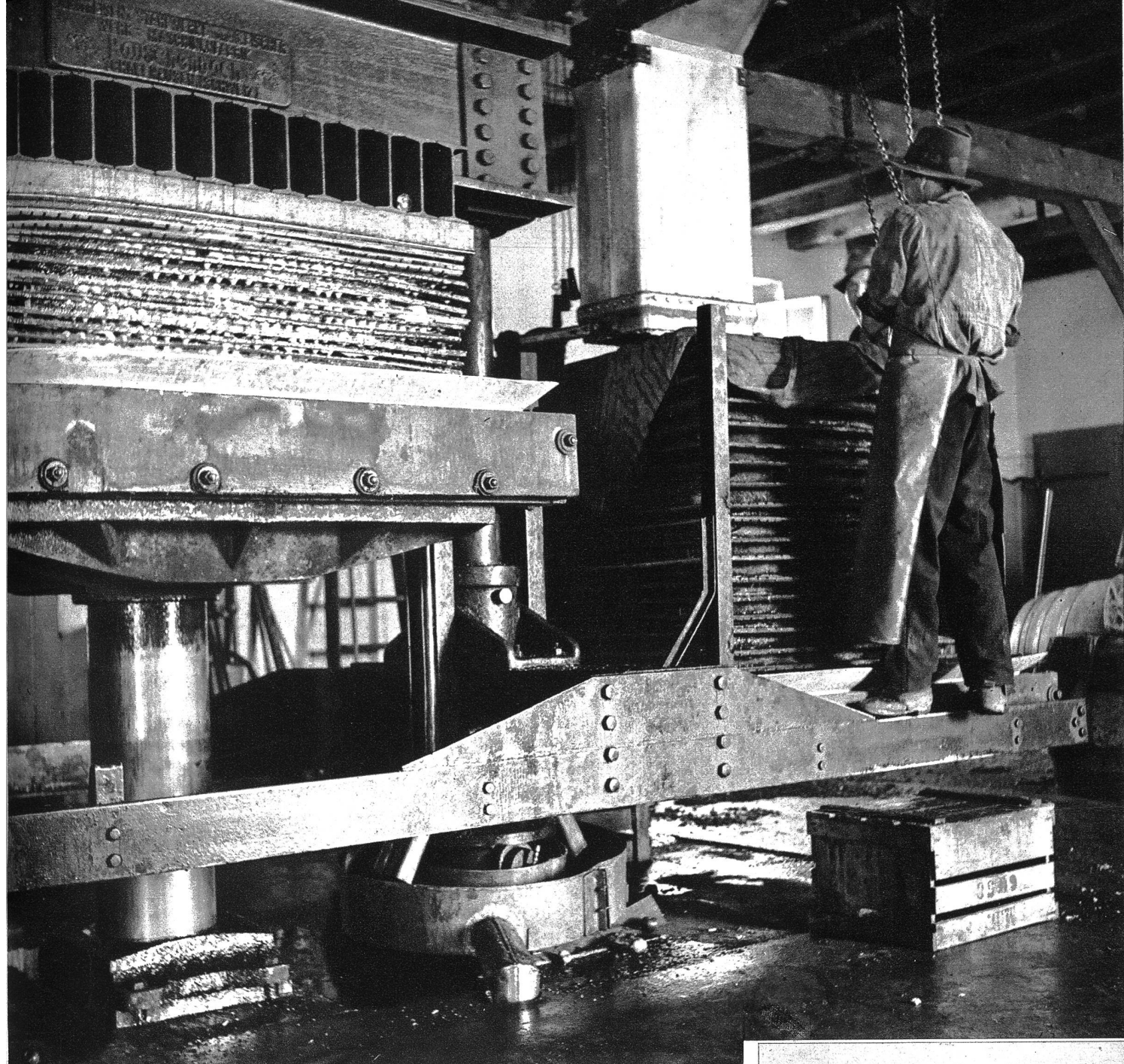
Der gepresste Druck (22 Tonnen) links wird bald ausgeschwenkt und dann kommt das sorgfältig aufgeschichtete Gut an die Reihe.
