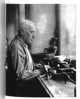
Der Stein muss während des Schleifens mehrmals umgestellt werden. Bei jedem Stein werden 68 Facetten in genau festgelegter Winkelstellung geschliffen. — Es gibt oft Stücke, die eine derartige Kleinarbeit aufweisen, die kaum mit nacktem Auge wahrgenommen werden kann
