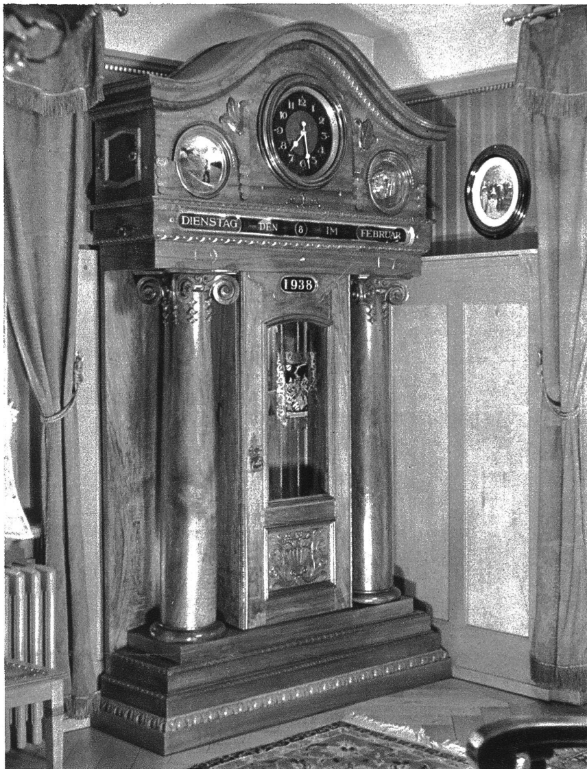
Grosse Barock-Uhr, die nebst der Tageszeit noch den Wochentag und den Monat anzeigt. Alle vier Jahre wird der 29. Februar automatisch registriert. Rechts neben dem Zifferblatt befindet sich ein Barometer und links davon ein Bild, das die jeweilige Konstellation des Mondes genau anzeigt. Auf den Uhrenzeigern befinden sich noch drei Miniaturührchen, welche Sekunde, Minute und Stunde anzeigen. Diese Uehrchen laufen ohne aufgezogen zu werden.
