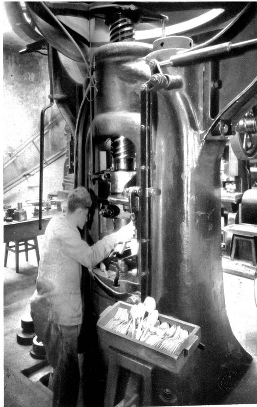
An dieser Maschine werden Tischbestecke geprägt
