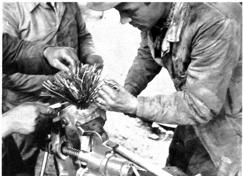
Der Seilkopf ist eingespannt; jeder Draht wird nun umgebogen, um ein Ausgleiten zu vermeiden
