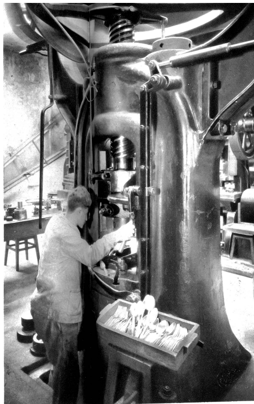
An dieser Maschine werden Tischbestecke geprägt
