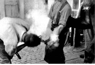
Das glühende Eisen wird angepasst.
