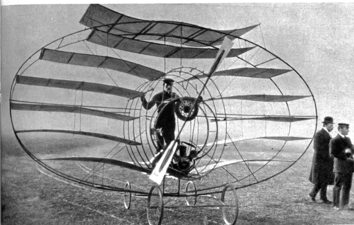
Der Franzose Givaudan ordnete 1909 den Flugzeugrumpf zwischen zwei grossen Trommeln an, die die Tragflächen ersetzen sollten. — Die von ihm verwendeten technischen Mittel waren so dürftig, dass der Tonnenflieger ohne Erfolg blieb
