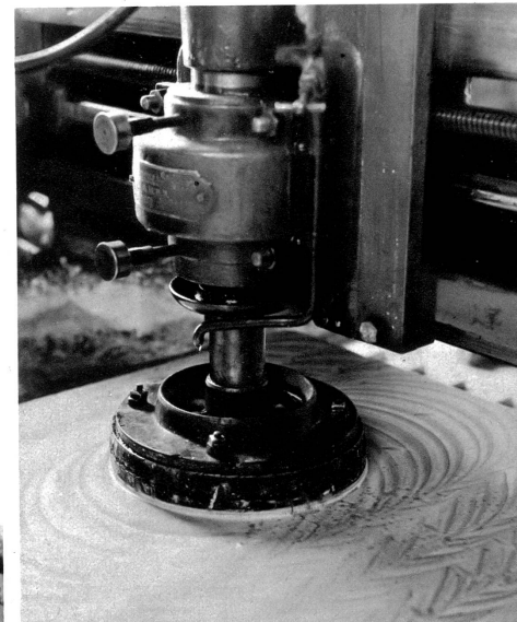
Schleifen des Lithographiesteines
