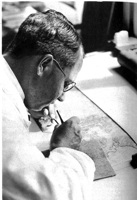
Der Kartograph beim Gravieren der Karte
