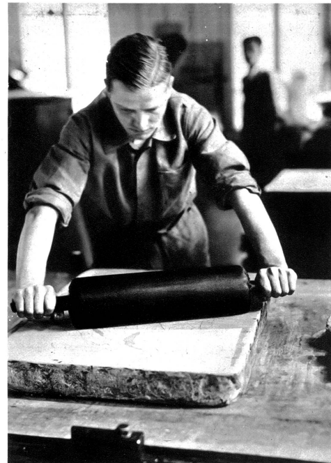
Der Stein wird eingefärbt um Probeabzüge herzustellen
