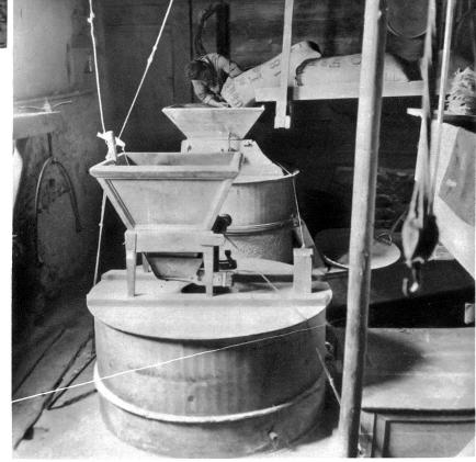
Im obern Stock der Mühle wird das Korn eingeschüttet. Durch das draussen munter plätschernde Wasserrad wird das Getriebe in Gang gesetzt.
