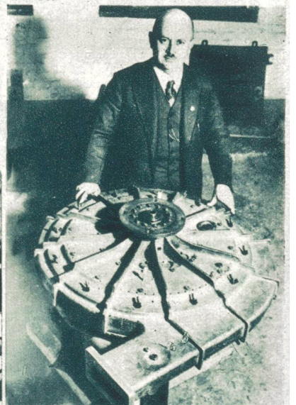
Ein deutscher Ingenieur erfindet das Dampf-Flugzeug. Der Berliner Ingenieur Hüttner hat das Dampf-Flugzeug erfunden. Das Flugzeug trägt einen Turbinenmotor mit 2500 PS. Leistung. Seine Länge wird 21 Meter und seine Breite 33 Meter betragen. Die Beheizung des Kessels geschieht durch Oelgas. Hüttners Erfindung besteht darin, daß er den Drehkessel erfand, der mit der Turbine zu einer Einheit verschmolzen ist. Turbine und Kessel drehen sich, von ausströmendem Dampf getrieben, gegenläufig. Den Berechnungen nach wird das Flugzeug mit einer Maximal-Geschwindigkeit von 380 Std.-Km. starten. Unser Bild zeigt Obergeringenieur Hüttner vor dem Modell der Dampf-drehkesselturbine.
