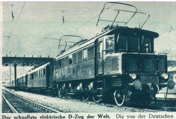
Der schnellste elektrische D-Zug der Welt. Die von der Deutschen Reichsbahn der A. E. G. in Auftrag gegebene neueste Schnellzugslokomotive erreichte auf der Probefahrt eine Höchstgeschwindigkeit von 151,5 km in der Stunde. Der Zug konnte aus dem Stillstand in 2½ Minuten auf eine Ge-
