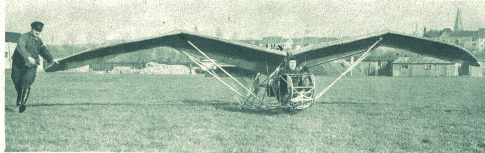
Ein neues Sportflugzeug. Der bekannte Flieger Hans Richter führte mit seinem neuen Flugzeug, das auf der Deutschen Luftsport-Ausstellung ausgestellt war, den ersten Startversuch auf dem Tempelhofer Flughafen aus. Durch die vogelartigen Tragflächen soll das Flugzeug eine besonders gute Flugstabilität erhalten. Unser Bild zeigt Hans Richter im Flugzeug während des Startversuchs. Wide World, Zürich.
