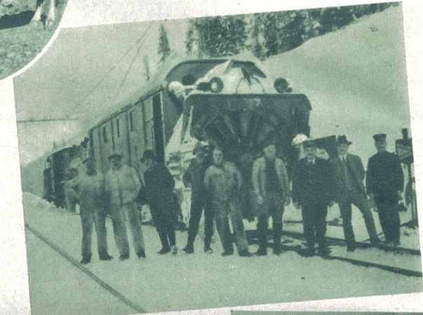
Die Schneeschleudermaschine der Rhätischen Bahn (im Bilde links) in voller Aktion auf Station Laret bei Davos. Die Schleudermaschine in der Nähe, mit Bedienungsmannschaft. Phot. A. Wegmann, Ragaz.
