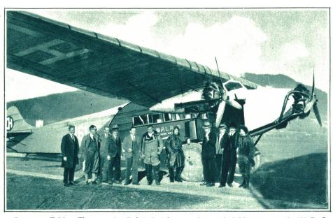
Das neue Fokker-Flugzeug der Balair Basel, ausgerüstet mit 3 Motoren von je 300 P. S., 200 km Stundenleistung, traf in Basel ein, weitere drei folgen demnächst. Photo Aviatik beider Basel.
