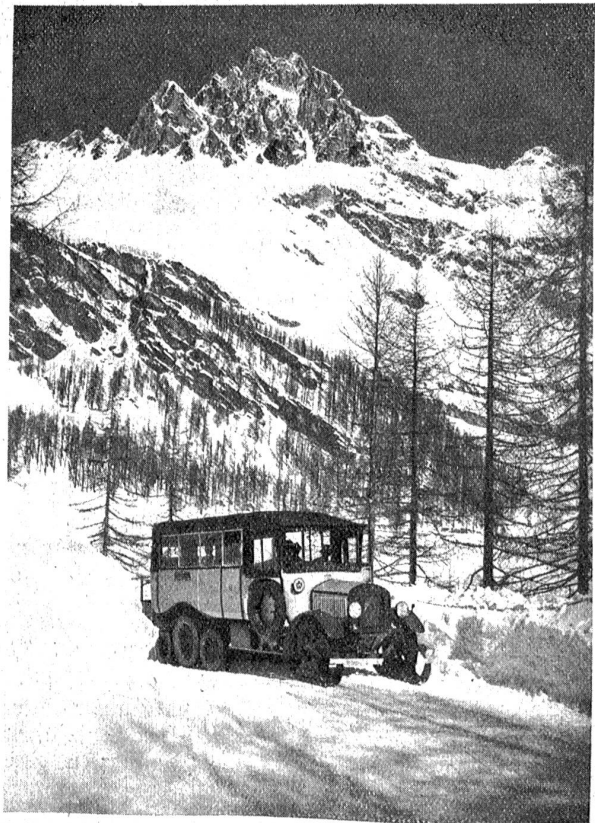
Der Raupenbandwagen, wie er für Winterbetrieb auf den Strecken Reichenau—Waldhaus Flims, Chur—Lenzerheide und St. Moritz—Maloja—Castafagna verwendet wird.
