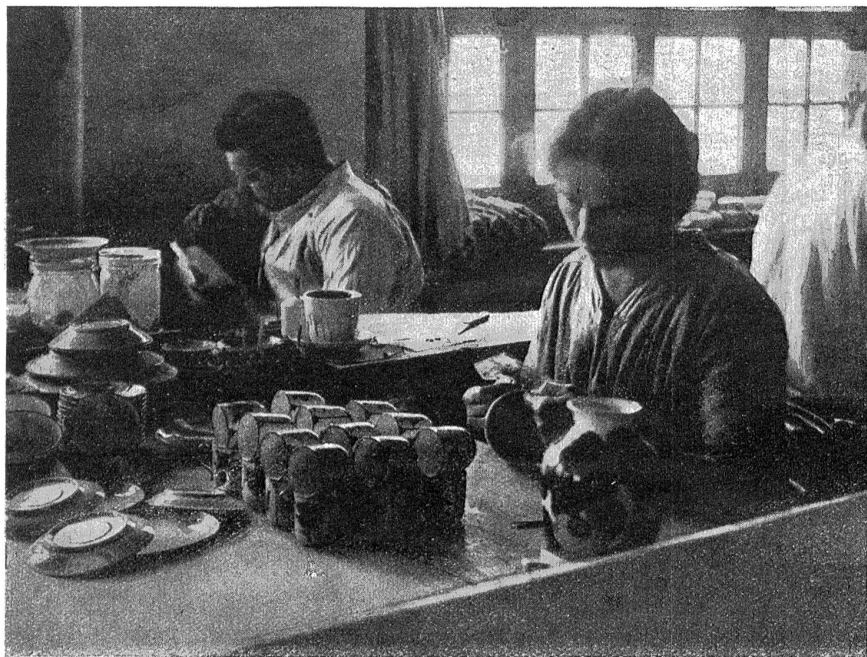
Dekoration der Tassen mittelst Abziehbildern; im Hintergrund Handmalerei.
