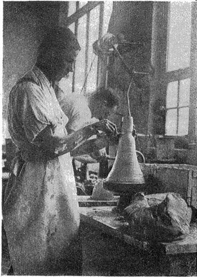
Der Hubel wird mittels Messer vom Rest der Porzellanmasse losgetrennt.
