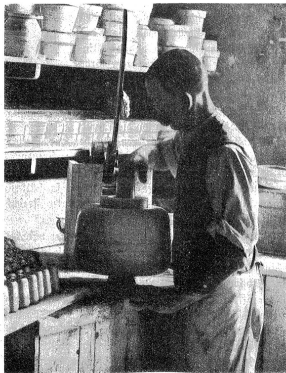
Einfügen des Hubels in die Gipsform. Die Gipsform selbst steckt in einem hohlen auf der Drehscheibe stehenden Aufsatz.
