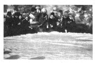
Brennender Oeltank wenige Sekunden später mit einer 20 cm hoben Schaumschicht.
