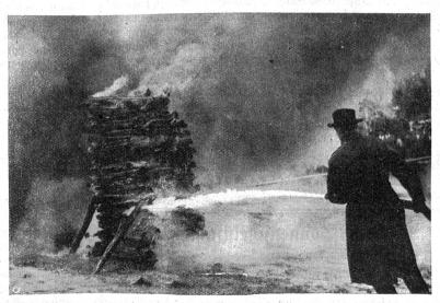
Cofchen eines brennenden holzstoßes. Der Schaum bricht wie ein Wasserstrahl aus dem Wendrohr hervor.
