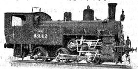
Lokomotive der Strecke Paola-Cosenza (Italien). Zwei getrennte Criebwerke für Adnällons- und Zahnradbetrieb.
