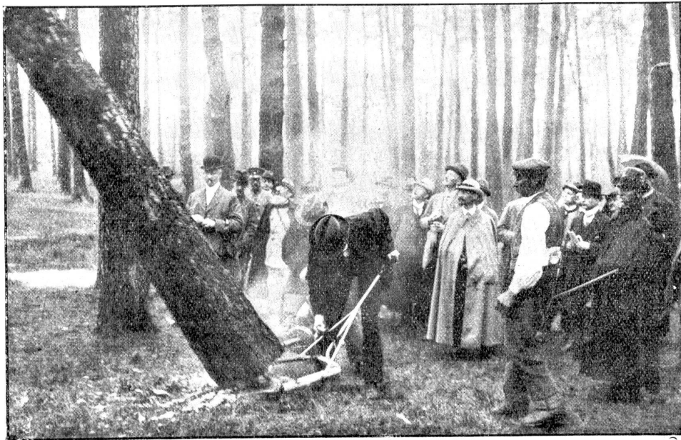
Bilder vom Kriege: Deutsche Motor-Baumfäll- und Sägemaschine.
