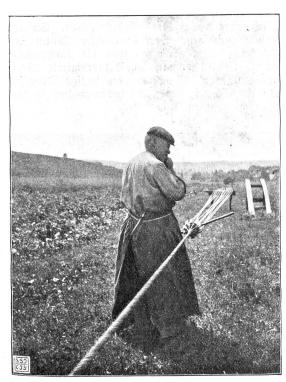
Ceitholzführer beim Verseilen eines Drahtseils durch handfabrikation.
