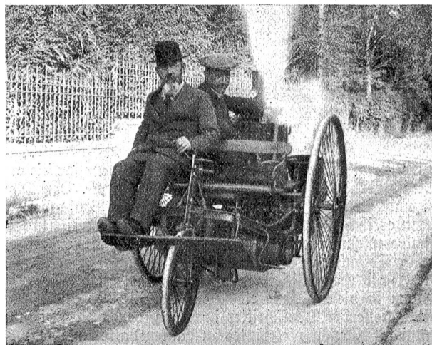
Dampfiredrad des Genfer Ingenieurs Chury, das älteste schweiz. Automobil.
